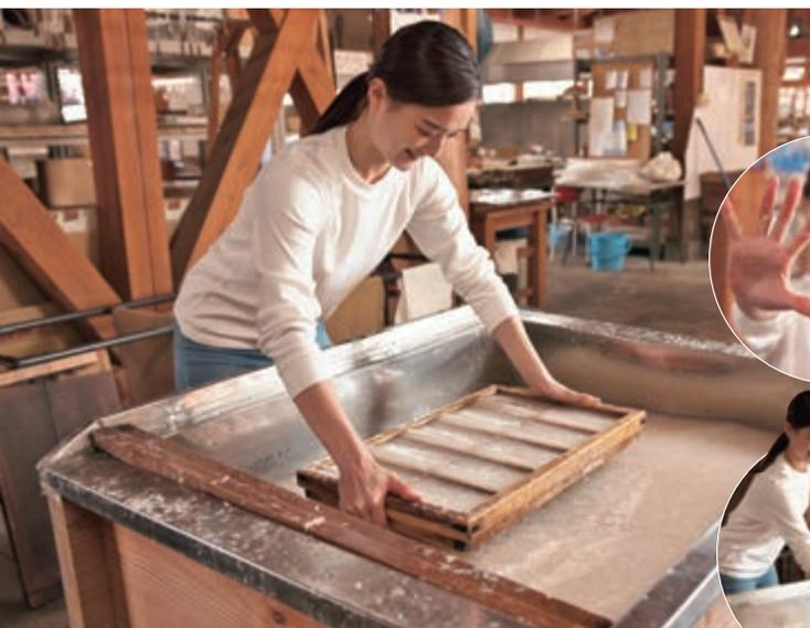
「水平に…」と簀桁を慎重に上げる璃奈さん。すくう量が偏ると和紙の厚みにも偏りが出る。「もう一回！」と、漉き舟(槽)に戻し自ら紙料液をかき混ぜて再度トライ。
