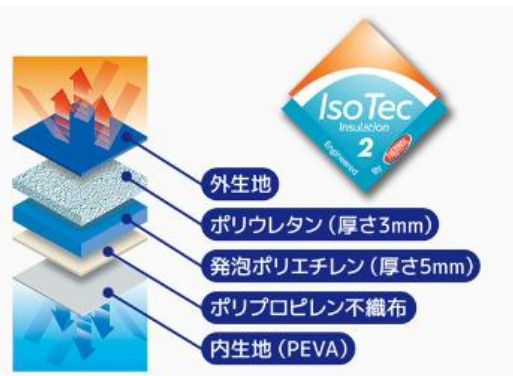
アイソテック2構造(5層構造)
