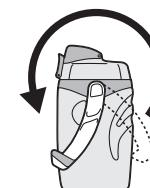
②本体を立てた状態で、ロックリングを矢印の方向に動かして解除します。
