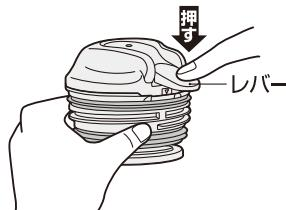
②レバーを押した状態で▼マークの下に指を入れキャップを引き上げて、はずします。
